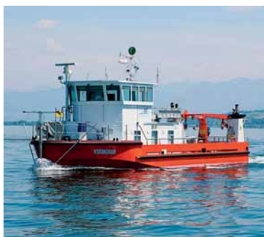
Vom Forschungsschiff Kormoran aus werden mit dem Fächerecholot am Bug Strukturen am Seeboden untersucht. Foto: ISF
