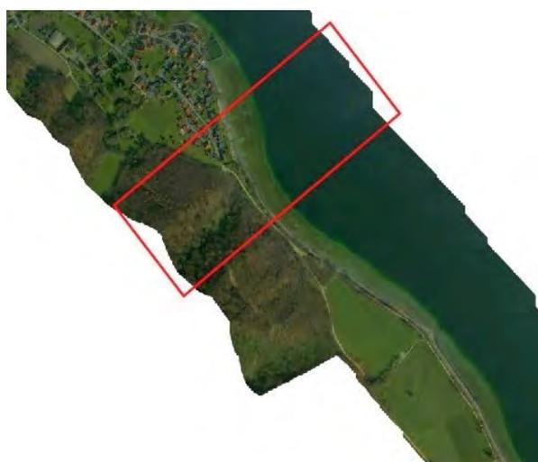
Abb. 4-21: Eine verbleibende Bildlücke nach der Triangulation (links) wurde durch das nachträgliche manuelle Einfügen fehlender Einzelbilder ergänzt (rot markiert, rechts).
