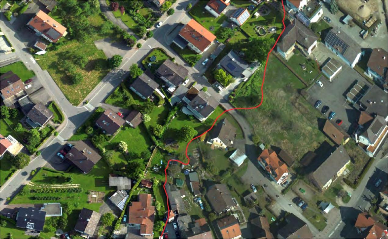
Abb. 4-24: Radiometrischer Unterschied der Luftbilder aus der Messkampagne im Sommer links (31. Mai/11. Juni 2014) und im Frühjahr rechts (29./30. März 2014). Die rot angedeutete Seamline zwischen den Bildern wurde von Hand angepasst, um einen Farbübergang in Gebäuden zu vermeiden.
