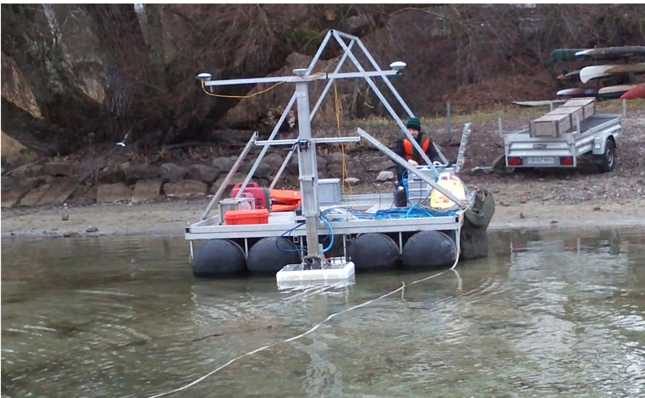
Abb. 3-8: Das Fächerlot Kongsberg EM2040 wurde für die Vermessung weniger, mit der Kormoran nicht zugänglicher Gebiete (z.B. bei Stein am Rhein) auf der Arbeitsplattform „Helvetia“ der ETH Zürich installiert.
