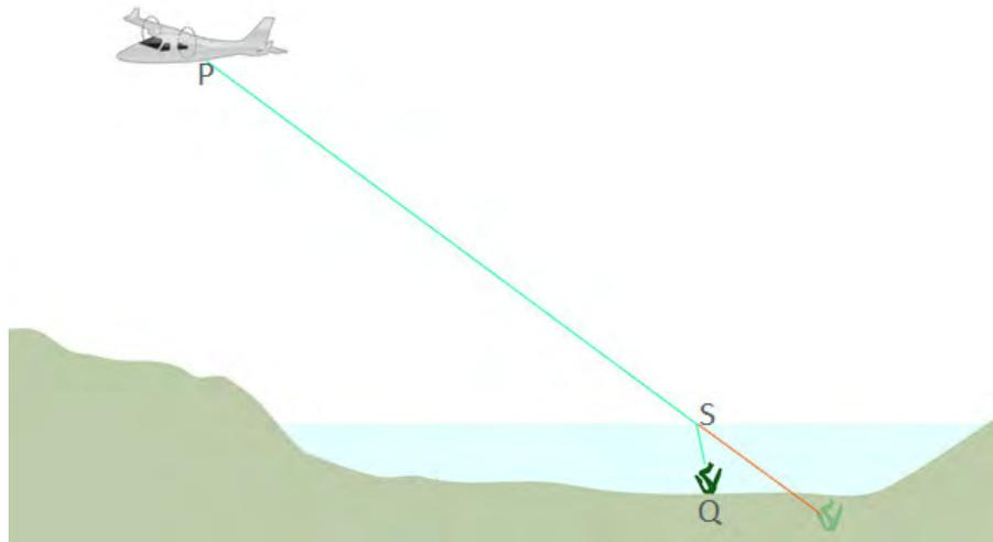
Abb. 4-15: Schematische Darstellung zur Berechnung der Refraktion.
