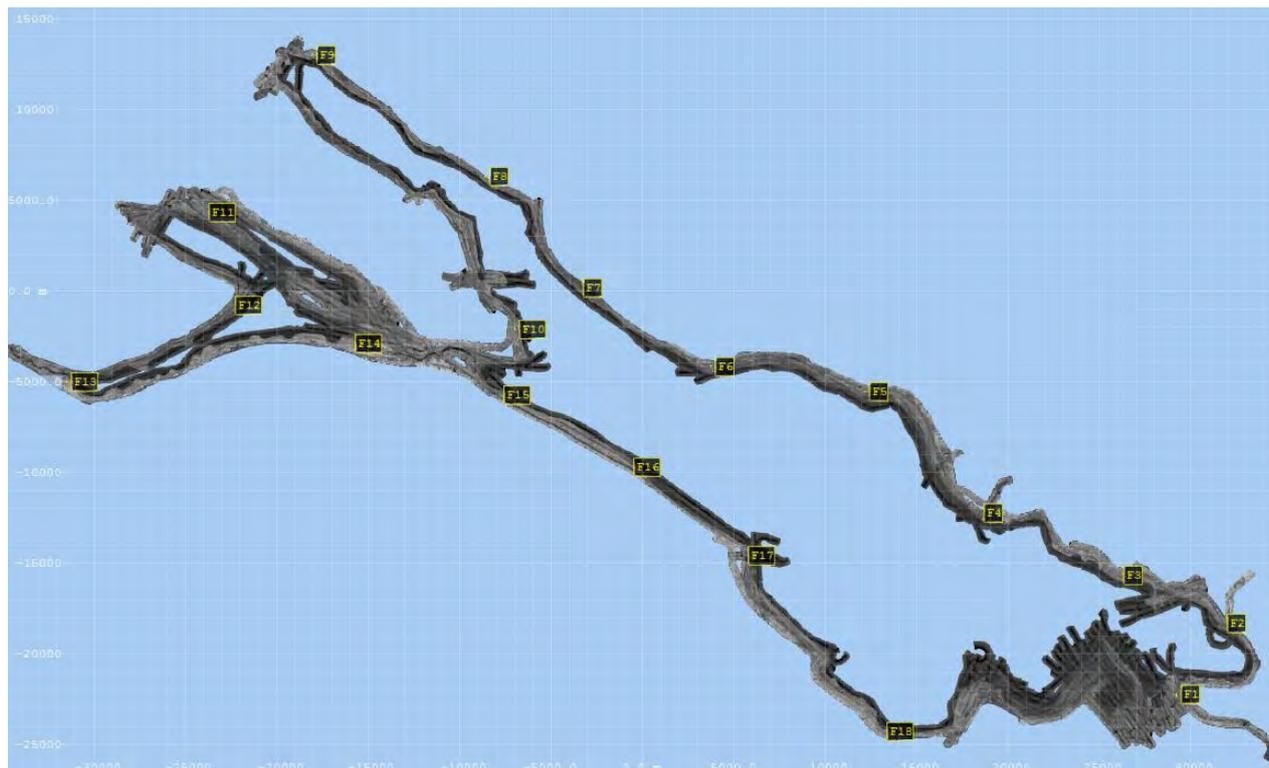
Abb. 4-6: Darstellung der topobathymetrischen Laserdaten des Bodensees in RiProcess und Lage der Passflächen (schwarze Kästchen mit gelbem Rahmen).
