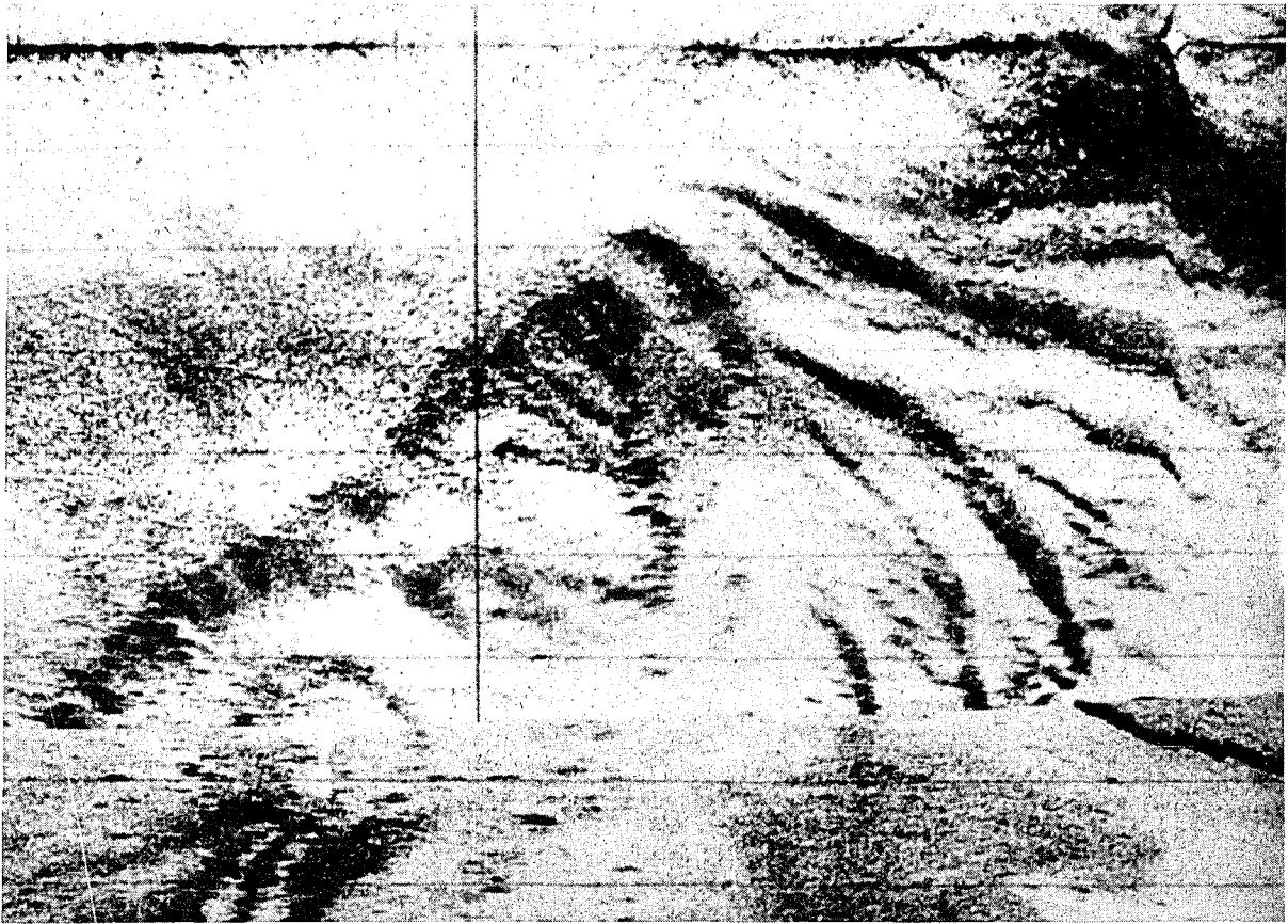
Abb. 26: Furchen an einer Rinnenflanke in 150 m Wassertiefe (Detail 8 in Abb. 20) Flächenausschnitt: 90m x 70m
