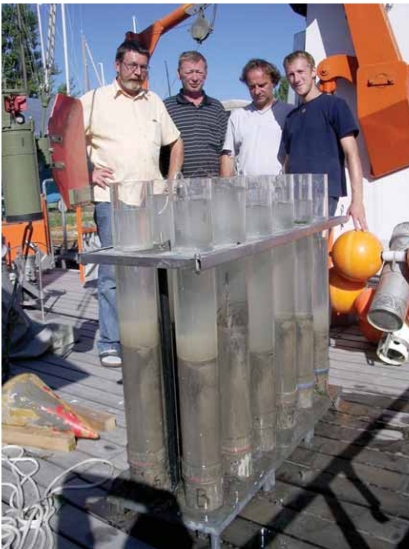
Sedimentfallenproben zur Analyse der saisonalen Entwicklung am Seeboden
