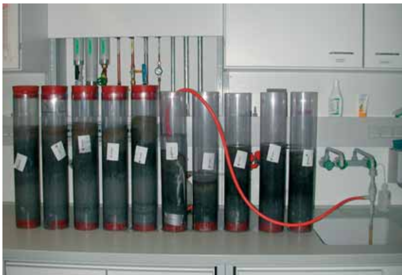
Aufarbeitung von Sedimentproben im Labor
