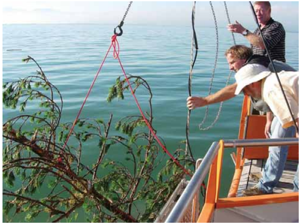
Hochwasserschaden: Ein Kiefernast blockierte den Strömungsmesser und verhinderte die Gewinnung weiterer wertvoller Messergebnisse.
