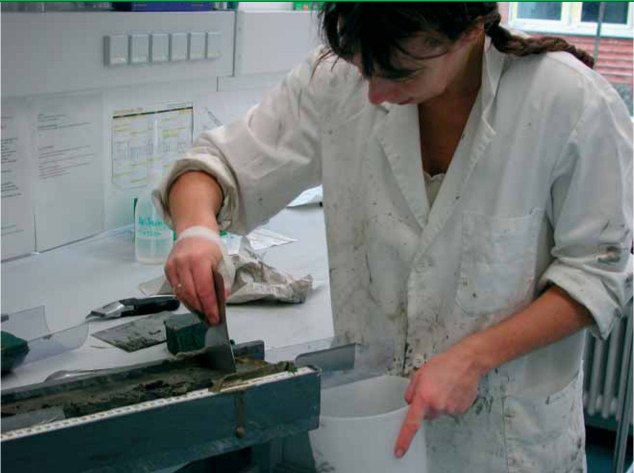
Eine Sedimentprobe wird im Labor schichtweise abgetragen und untersucht.
