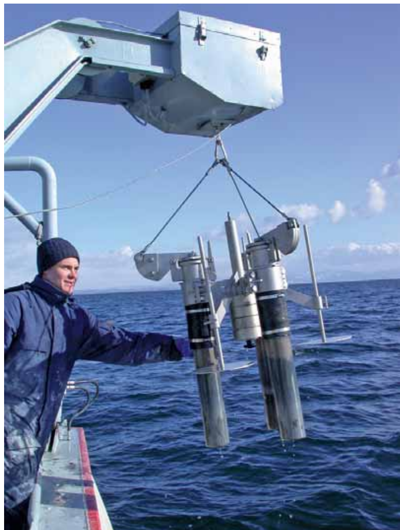
Mit dem MultiCorer werden die Proben der Sedimentoberflächen an Deck geholt.
