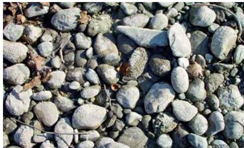
Standorttypische Substratmischung (Feinkies bis runde Wackeln) im Bereich des Böschungsfußes (Foto bei NW).
